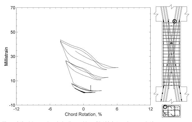
$Figure\ 350-Measured\ strain\ in\ diagonal\ bar\ of\ D100-3.5,\ strain\ gauge\ D12$
