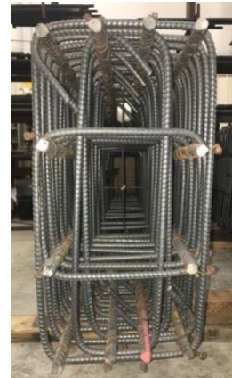
(d) Cross section of rectangular configuration 2 CWT specimen
